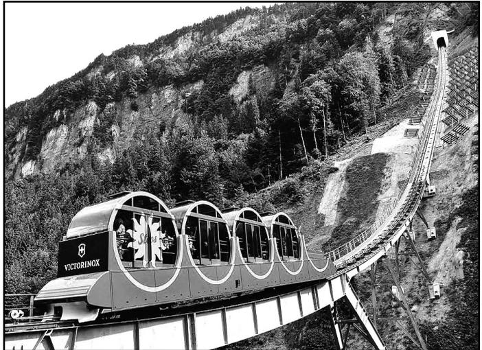
Die Fahrzeit beträgt 3-5 Minuten. Mit dem automatischen Niveauegleich der zylindrischen Fahrgastkabinen ist sie eine technische Besonderheit und bietet den Fahrgästen bei jeder Steigung des Trassees optimalen Komfort. Die Bahn wurde am 15. Dezember 2017 nach einer 4-jährigen Bauzeit eröffnet.
