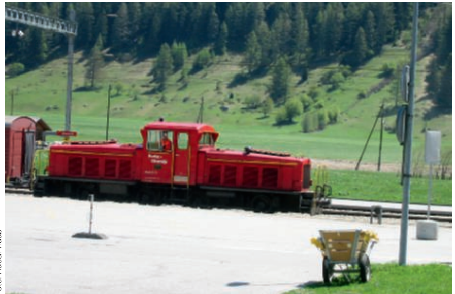
Auf dem Weg nach Grengiols angetroffen: Die Gm 4/4 71, in Oberwald im 2004, technisch gesehen ein «Krokodil», da einmal Einsatz in Finnland, «Elch» genannt. Hergestellt in der Arnold Jung, Lokomotiv-Fabrik. Unterdessen ist das Logo auf «Matterhorn/Gotthardbahn» umgespritzt worden. Sie wird zur Schneeräumung und Transporten auch von der dfb benutzt. / Rencontré sur le chemin vers Grengiols à Oberwald en 2004 : du point de vue technique, la Gm 4/4, produite dans les ateliers de locomotives Arnold Jung, est un « crocodile » ; aussi nommé « l'élan », car elle avait servi en Finlande, avant de venir au MGB. Depuis, le nouveau logo du « Matterhorn Gotthard Bahn » a remplacé celui du FO. La machine est aussi utilisée par le DFB pour le déneigement et pour les transports.
