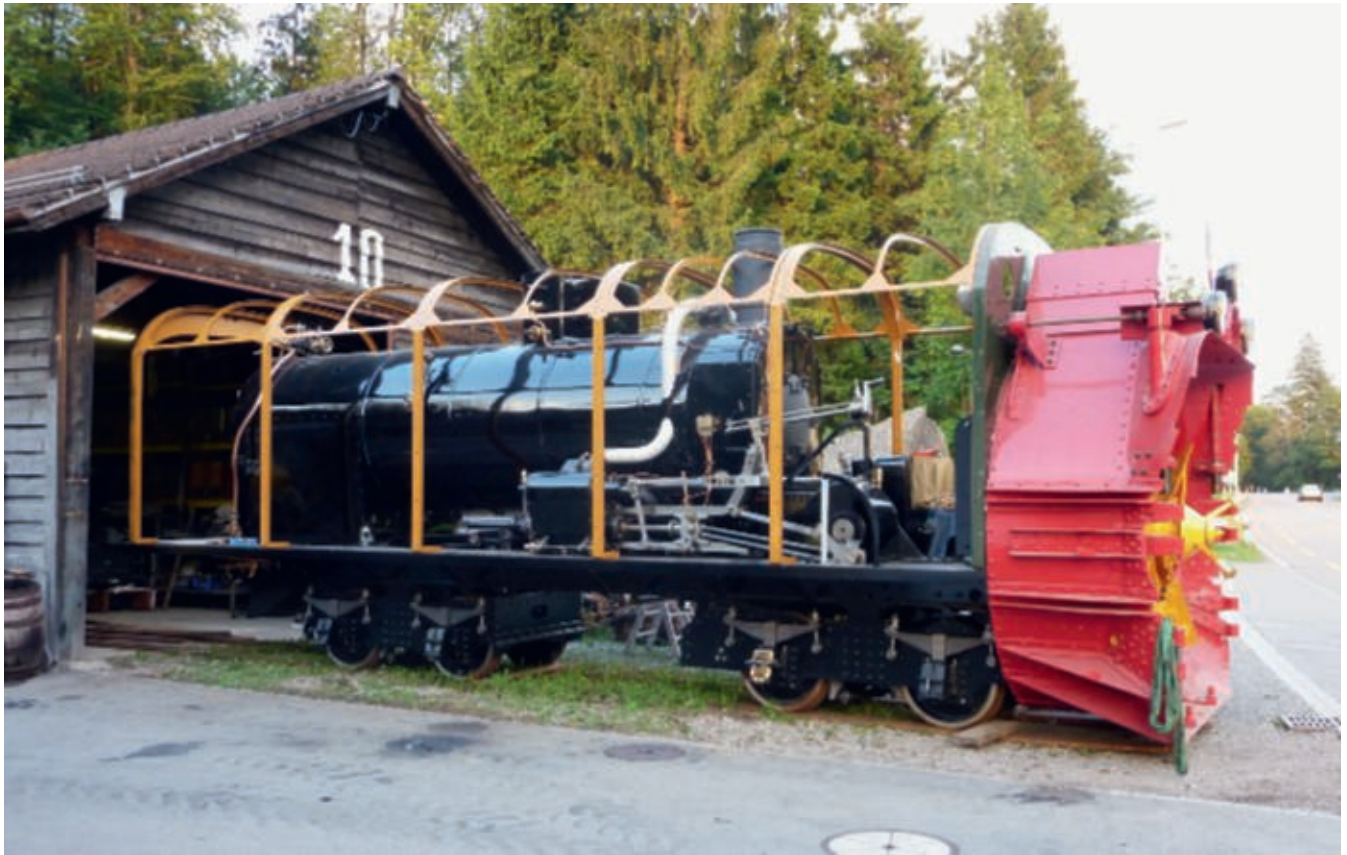
Die Dampfschneeschleuder Xrotd R 12 entsteht in Goldau neu. Le chasse-neige rotatif à vapeur Xrotd R 12 en cours de reconstruction à Goldau.
