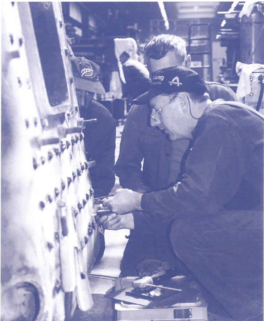
Es wird genau ausgemessen, in welchem Winkel die Auswaschbuchse einzubauen ist. Fotos: Gerhard Oswald
