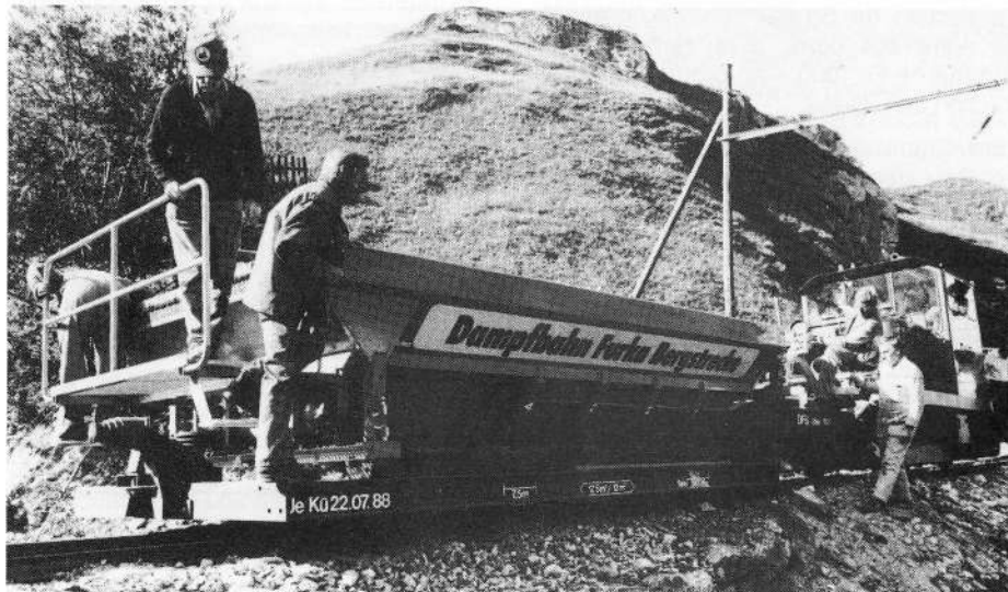
Jungfernfahrt des Ubw 1001 der DFB. Die automatische Entleerung funktioniert ein- wandfrei.
