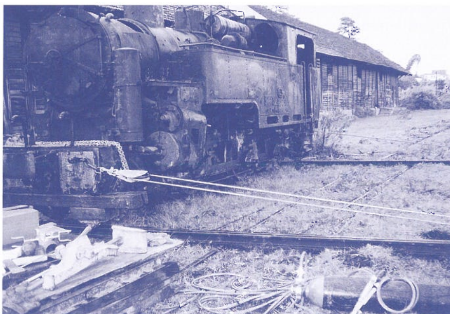
Dornröschen wird auf zwei Hilfsgleisen quer über vier Gleise gezogen
