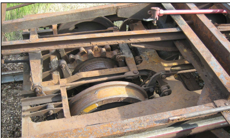
Das Drehgestell mit Bremszahnrad vor der Zerlegung
