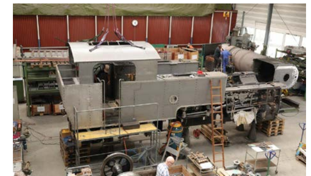
Am Führerhaus-Oberteil werden Befestigungslöcher auf Passgenauigkeit zum Wasser- und Kohlenkasten geprüft.
