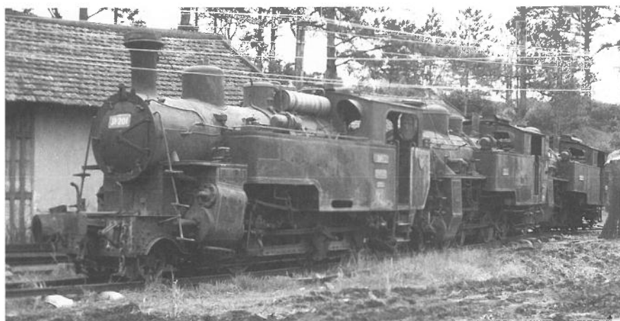
Vietnam: Lok HG 3/4 Nr. 1 und HG 4/4 Nr. 708 und 704 in Dalat. Der Unterschied bezüglich Innen- und Aussenrahmen ist gut zu sehen. Vietnam: loc HG 3/4 no. 1 et HG 4/4 708 et 704 à Dalat. La différence entre cadre intérieur et extérieur est claire.
