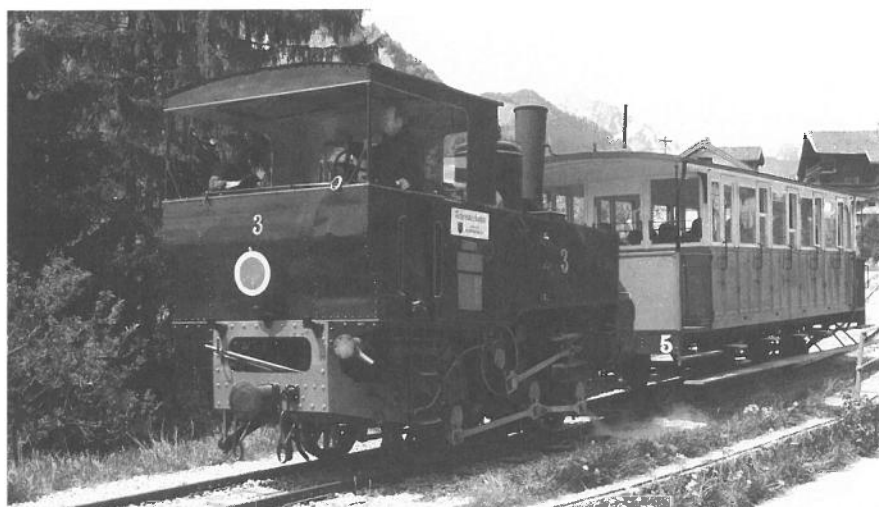
Lokomotive der Achenseebahn mit verkuppeltem Antrieb. Locomotive de l'Achenseebahn avec propulsion couplée.
