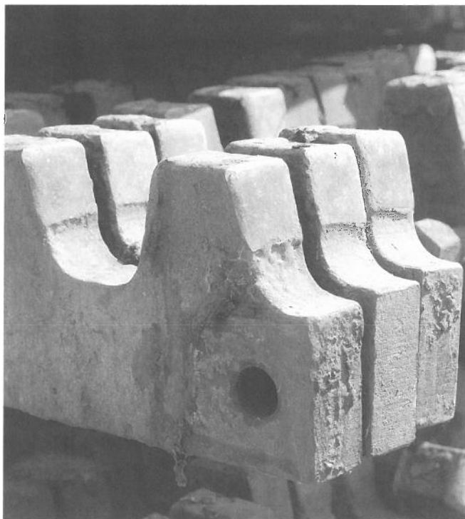
Zahnstangen mit Verschleisspuren können aufgearbeitet werden. Les crémaillères avec traces d'usure peuvent être refaites.
