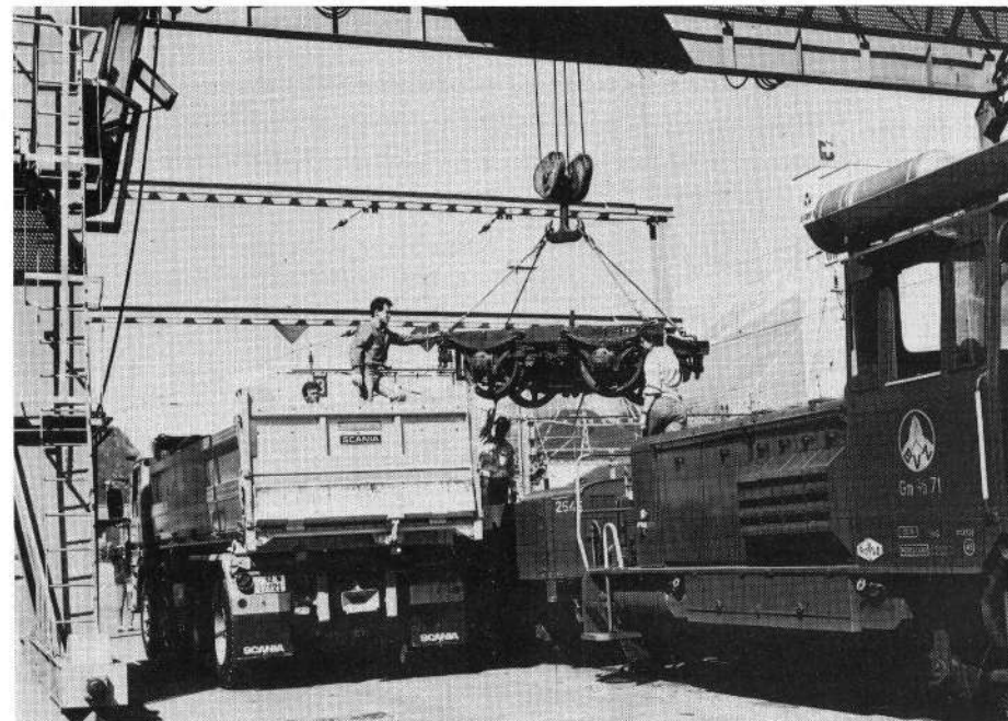
Brig-Visp-Zermatt-Bahn, Visp: Verlad der Laufdrehgestelle unter dem SBB-Portalkran von der BVZ auf den «DFB-Camion» von Beni Christen
