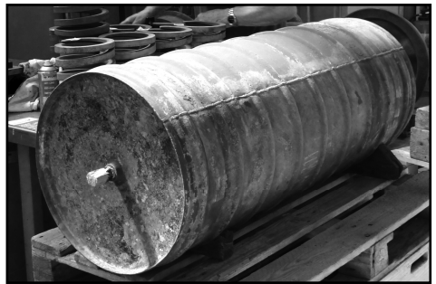
Gut erhaltener Sonderbehälter (Vakuumspeicher) vom Sklv der MGB
