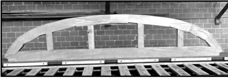
Verleimter Dachbogen vor der endgültigen Bearbeitung der Kontur
