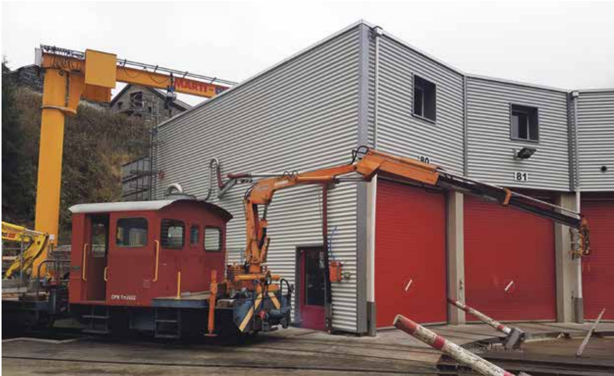
Der Tm 2922 mit ausgefahrenem Hydraulikkran vor der Werkstätte in Realp.
