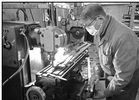
Fräsarbeit an Fensterscheren
