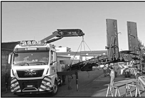
Das Chassis wird herausgehoben
