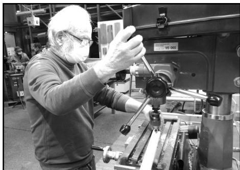
Bohren unzähliger Schraubenlöcher
