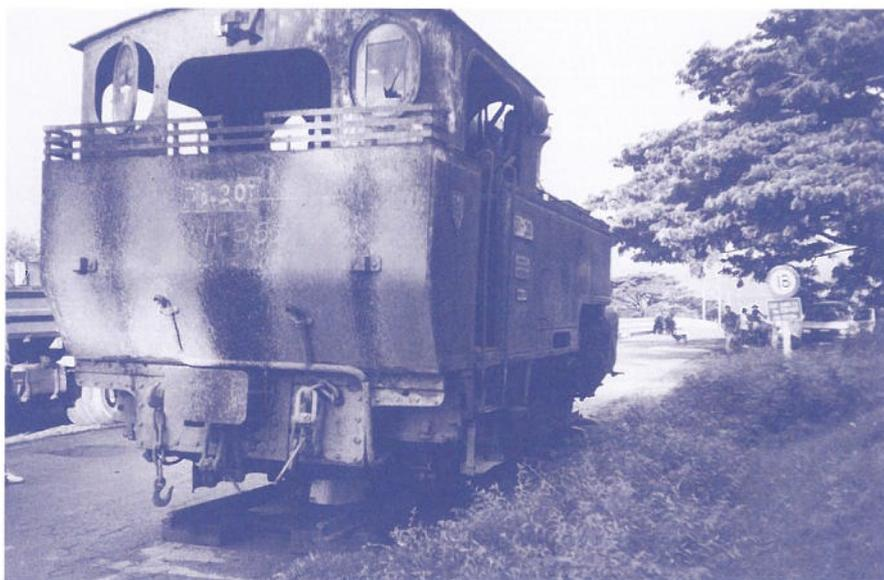
Auch diese ehemalige Furka-Lok HG 3/4 mussten wir vor der mit 18 Tonnen Maximallast angeschriebenen Brücke auf die Strasse abladen. Foto: Bruno Rütli
