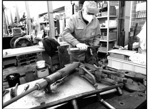
*Sämtliche Teile der Drehgestelle und der Bremsanlage werden sorgfältig gereinigt, geprüft und - wo nötig - überarbeitet und repariert*
