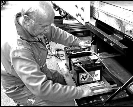
*Die Akkus sind in einem Kasten unter dem Chassisrahmen untergebracht.*
