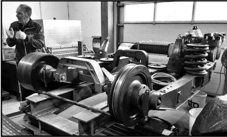
*Die Drehgestelle mit breiten flachen Rädern auf einer Seite sind eine Besonderheit. Sie ermöglichen das Befahren der Kreuzungsweiche in Streckenmitte ohne bewegliche Teile.*
