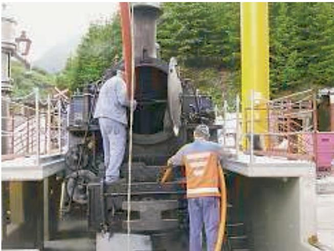
An der ersten Lok wird mit der neuen Absauganlage die Rauchkammer geleert. / La boîte à fumée de la première locomotive est vidée avec la nouvelle installation d'aspiration.
