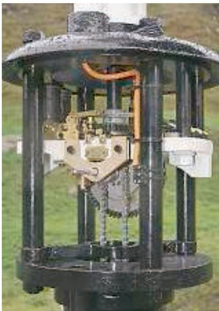
*Erneuerte Mechanik der Wendescheibe / Mécanisme révisé du signal à disque*
