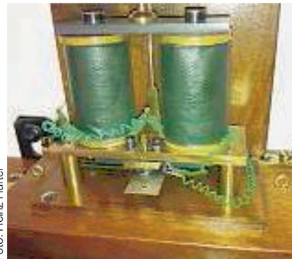
*Stellkasten mit der Doppelspule des Weckers / Armoire de commande avec la double bobine du réveil*
