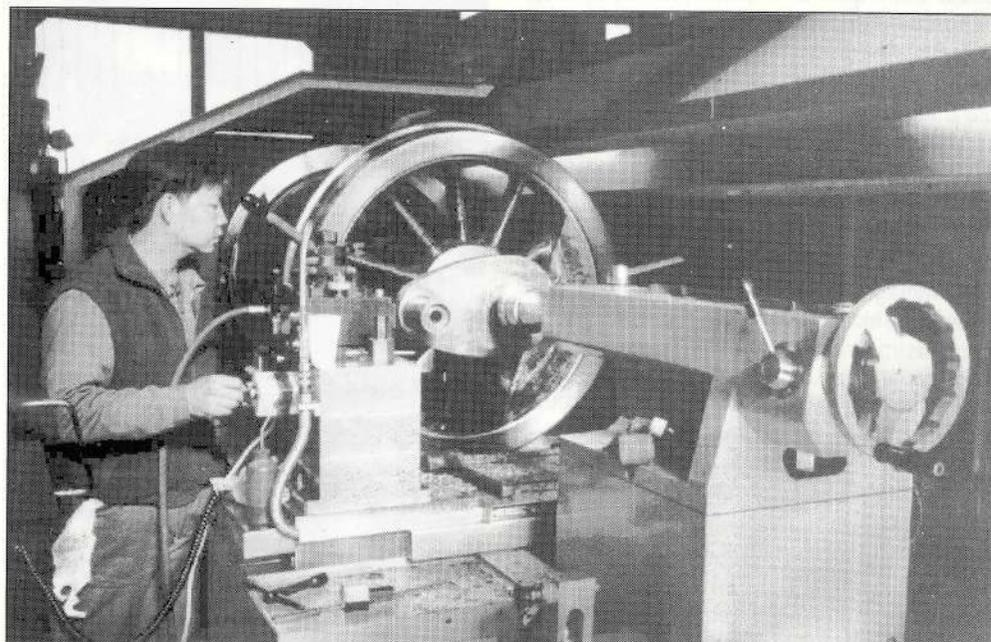
Chung Kim Toan aus Vietnam, poliert auf einer Grossdrehbank eine Achslagerstelle an einer der Achsen der FO 4. Foto: J. Zahnd
