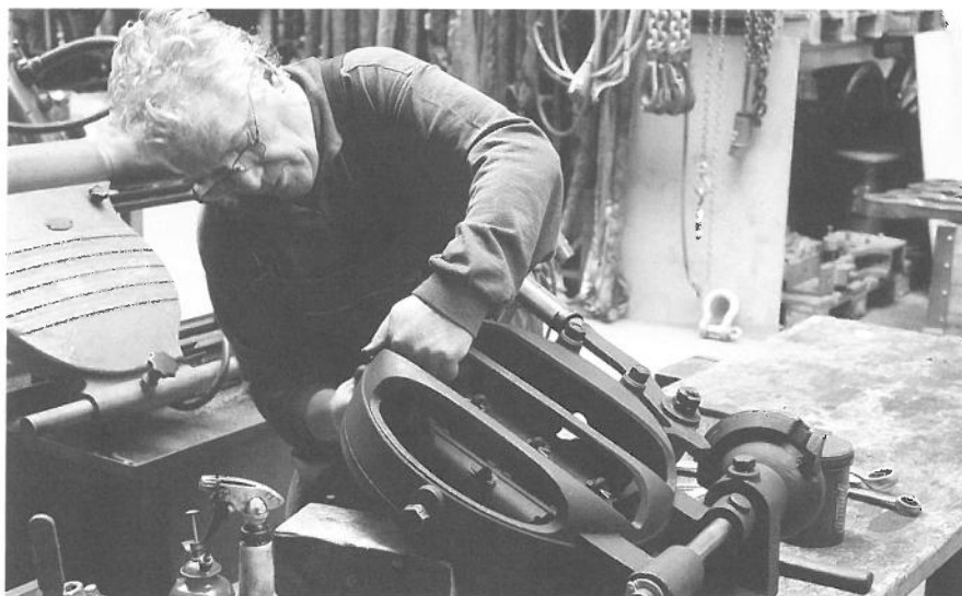
Letzte Arbeiten an der Feuerungstüre der Lok 4. – Finition de la porte de foyer de la loc 4.
