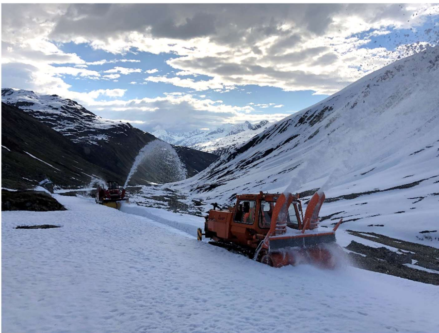
Die INTRAC Raupenfräse und die HGM 51 mit Anbaufräse bewegen sich langsam von der Sidelenbachbrücke Richtung Station Furka. Bild: Patrick Smit.
