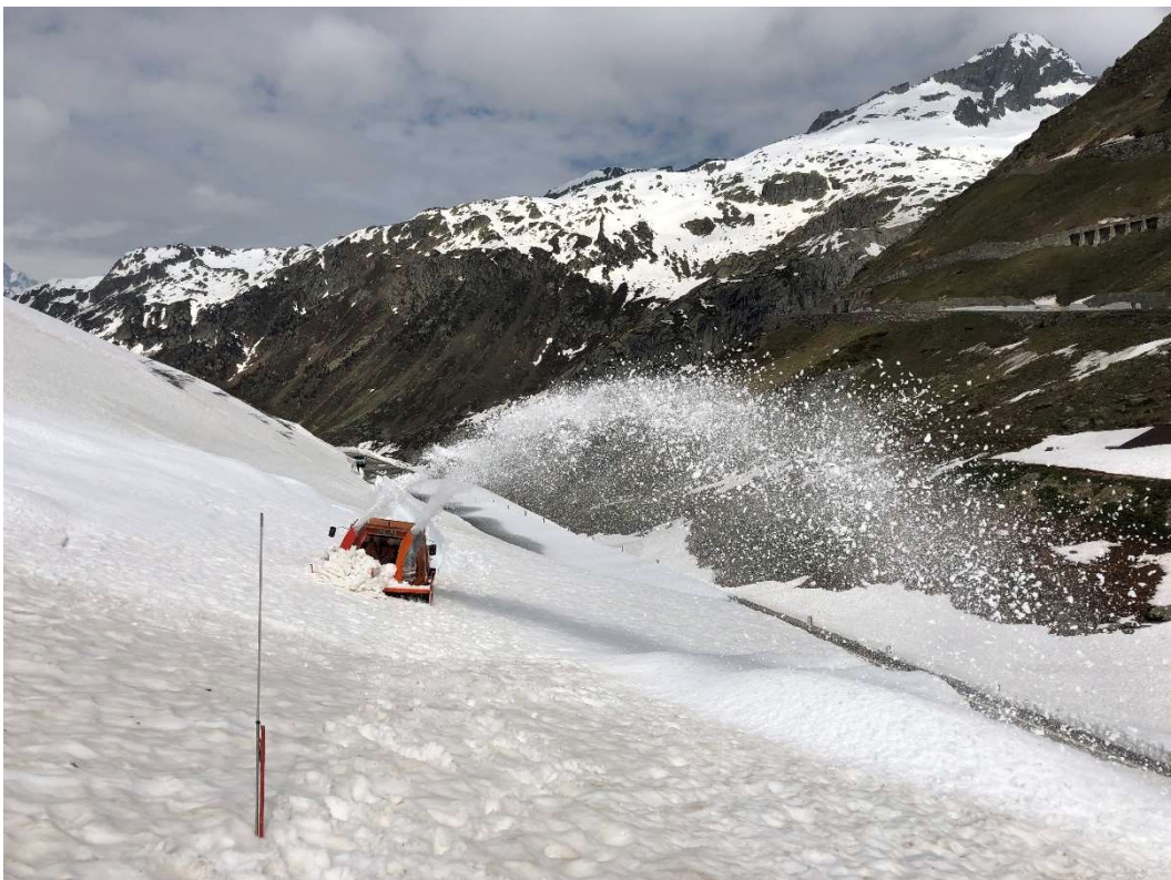
Die INTRAC Raupenfräse fräst sich vom Bahnübergang Furkastrasse langsam Richtung Station Muttbach-Belvédère. Wegen den vielen Schneerutschen beträgt die Räumhöhe bis 4 m.
