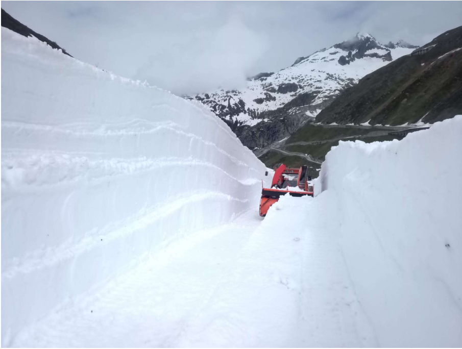
8.6.2021: Die INTRAC Raupenfräse irgendwo zwischen dem Bahnübergang Furkastrasse und der Station Muttbach-Belvédère. Bild: Martin Wieland.
