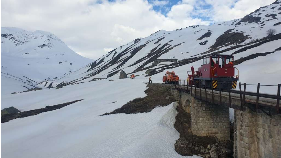
Die HGM 51 mit Anbaufräse folgt der INTRAC Raupenfräse. An der Spitze des Konvois messen Reto Alber und Fred Schönthal die Gleisachse ein. Bild: Michael Bühler.
