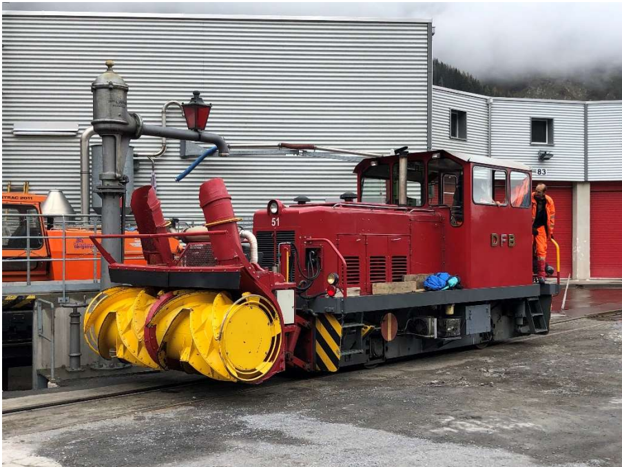
Nach der Montage der Anbaufräse übergibt Patrick Smit im Stützpunkt Realp die HGM 51 Erik Fornallaz und Oliver Rusterholz. Diese machen sich sogleich auf dem Weg zu ihrem Einsatz zwischen der Steffenbachbrücke und dem Steinstafelviadukt. Urs Züllig und Fritz Gerber begleiten das Frästeam. Bild: Patrick Smit.
