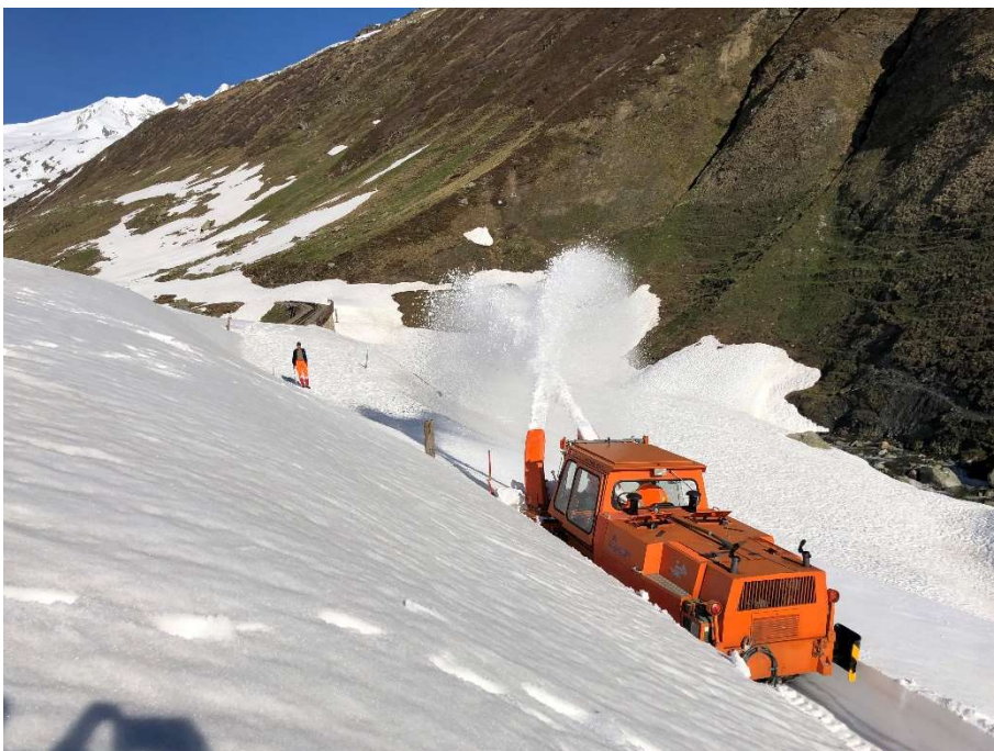
Die INTRAC Raupenfräse kurz vor dem Steinstafelviadukt. Bild: Patrick Smit.
