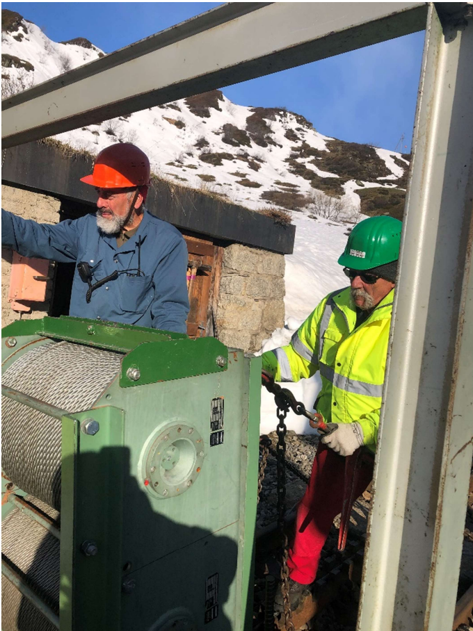
Berthi Camenzind und Toni Meier nehmen die hydraulische Winde in Betrieb. Bild: Karlheinz Felder.
