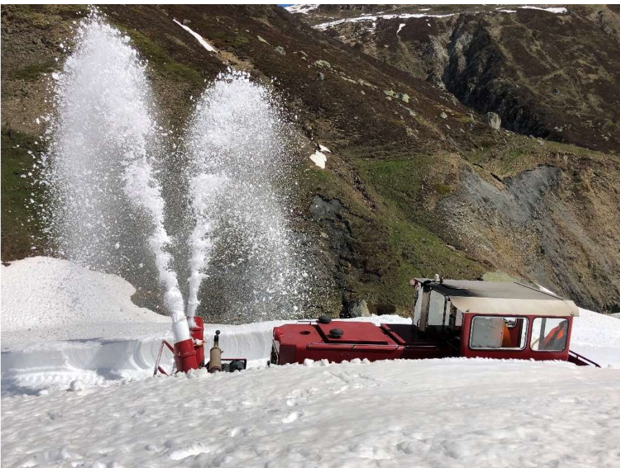
Die HGm 51 mit Anbaufräse kurz vor dem Steinstafelviadukt. Bild: Patrick Smit.
