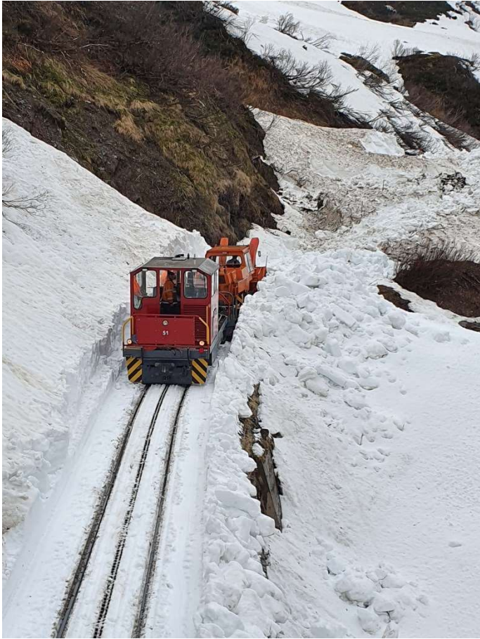
Mit dem Tiefgänger bringt Patrick Smit die INTRAC Raupenfräse bis vor den grossen Schneerutsch zwischen Tunnel 2 und Tunnel 1. Bild: Michael Bühler.
