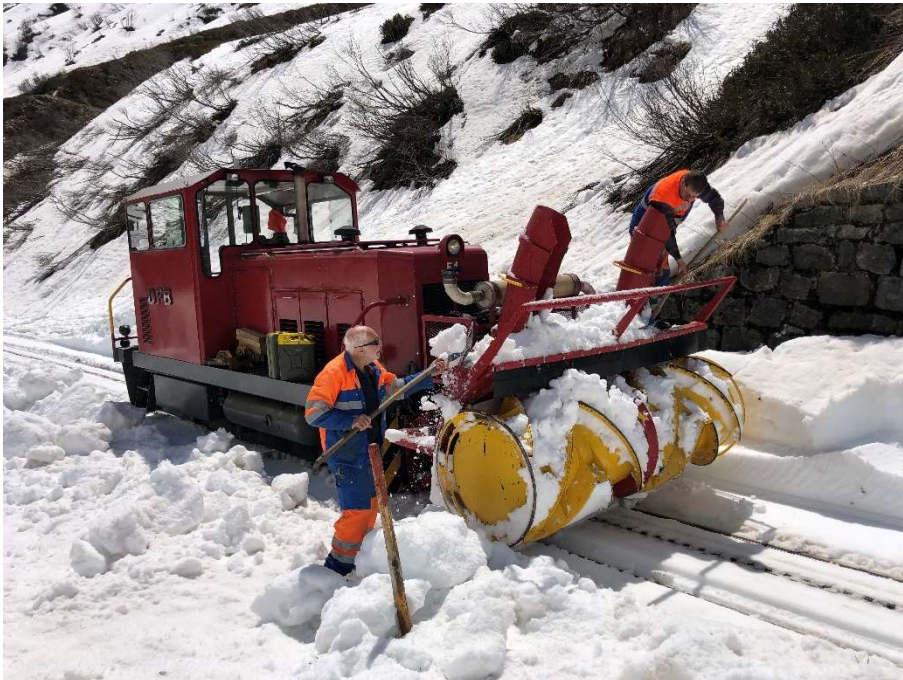
Fritz Jost und Michal Bühler öffnen die vom durchnässten Schnee verstopften Auswurfkamine der Anbaufräse. Bild: Patrick Smit.
