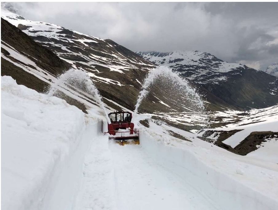
Die HGm 51 mit Anbaufräse fräst den letzten Rest Sulzschnee vom Gleiskörper weg.
