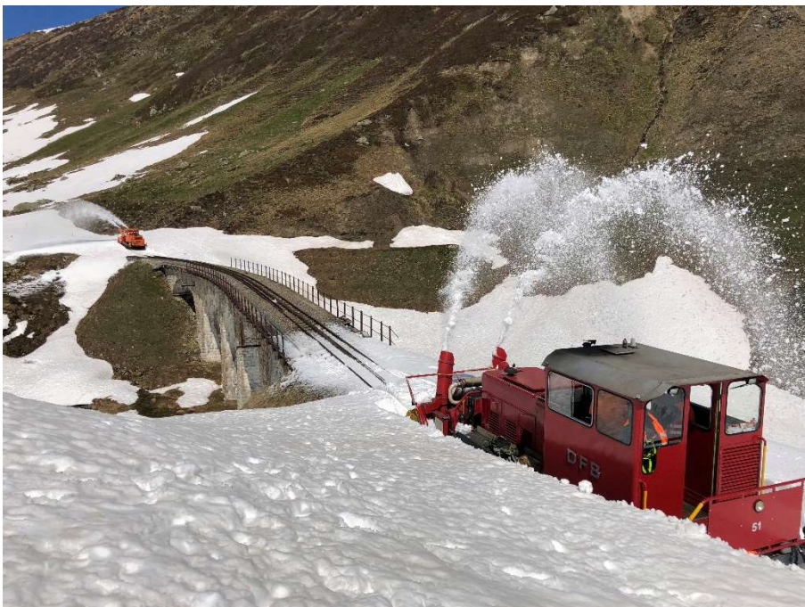
Während die HGm 51 den letzten Schnee vor dem Steinstafelviadukt fräst, fräst sich die INTRAC Raupenfräse auf der anderen Seite des Viadukts in den nächsten meterhohen Schneerutsch. Bild: Patrick Smit.
