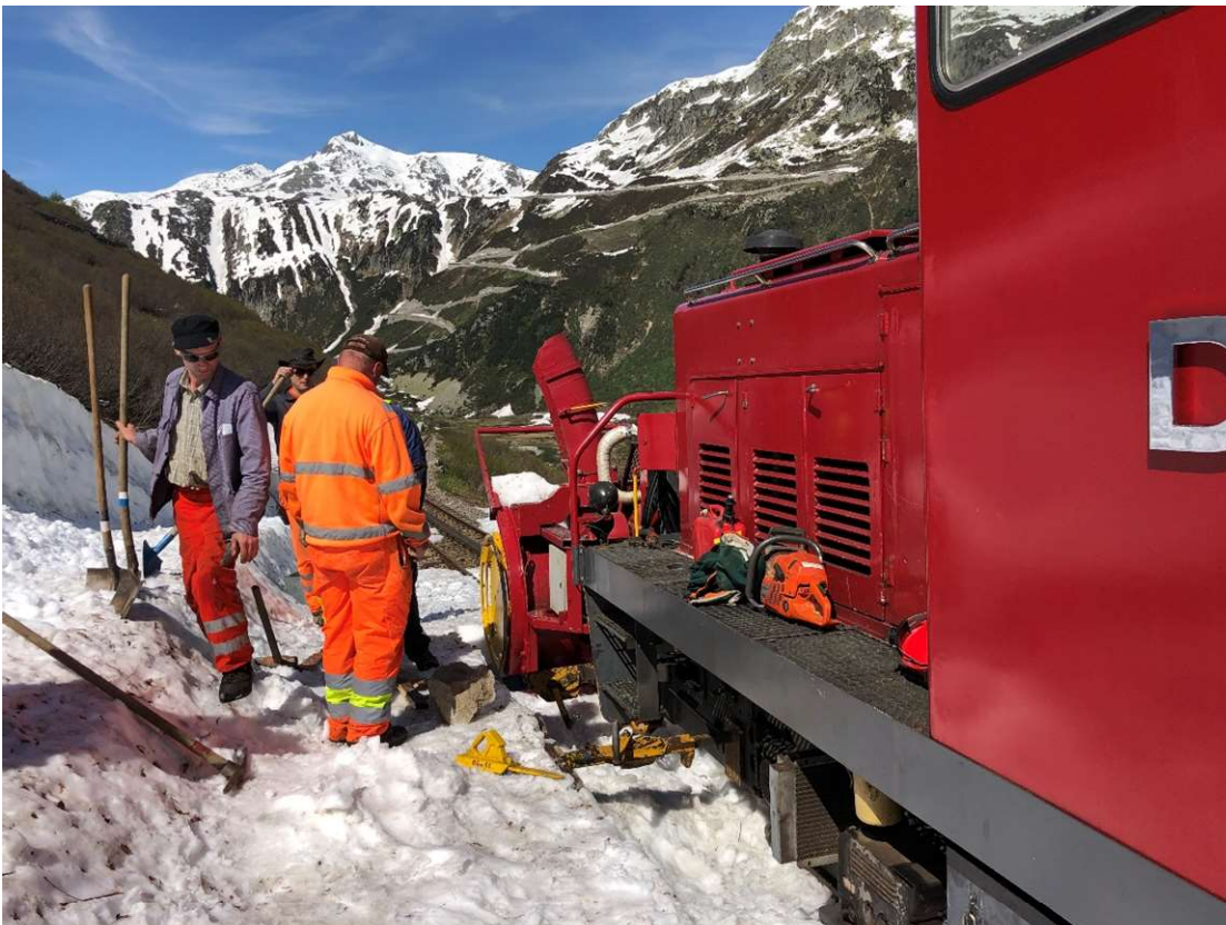
12.6.2021: Unmittelbar vor Abschluss des Fräsens mit der Anbaufräse entgleist die HGM 51 zwischen der Hilfsbrücke und Bahnhof Gletsch mit der vorderen Achse. Mit Stockwinden, Gleitplatten und Holzbalcken gleisen wir die HGM 51 wieder auf. Bild: Patrick Smit.
