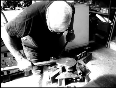
*Biegen der dickwandigen Anschlussrohre der Dampfheizung*
