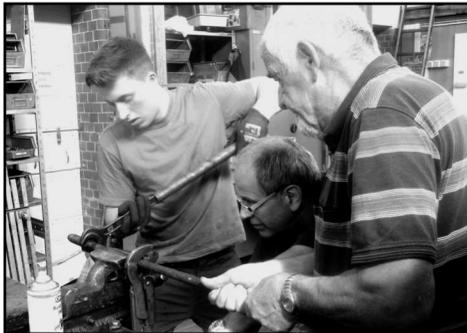
*Lösen von feststehenden verrosteten Schraubverbindungen des Bremsgestänges des Drehgestells mit vereinten Kräften.*
