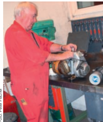
Eugen kontrolliert einen Kleingenerator mit Zweitaktmotor / Eugène contrôle un petit générateur à moteur 2 temps
