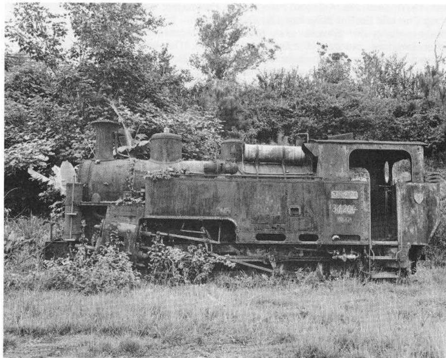
Juni 1988, Vietnam, Da Lat: Leider im Freien rostet die FO-Lok Nr. 9 seit Jahren still dahin. Die mit VHX 31-204 klassierte Maschine war wegen Zylinderriss im Zahnradteil zuletzt nurmehr im Adhäsionsbetrieb als Rangierlok eingesetzt
