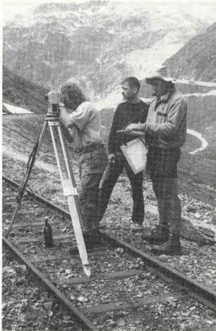
Tachymetrische Aufnahme im Bereich Muttbach/Belvédère. Aufnahme: Thorsten Jungmann
