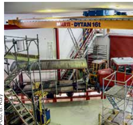
Der fertig montierte und betriebsbereite Hallenkran im Februar 2014. Die Kranbahnen wurden in eigener Regie konstruiert. Dafür waren umfangreiche Gerüstarbeiten nötig.
