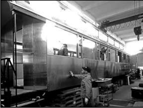
Die Bleche wurden vor dem Lackieren probemontiert
