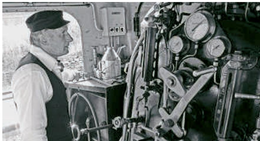
Heizer Josef Grandl fixiert das Kesseldruck-Manometer. Der Zeiger zittert zwischen 13 und 14 bar. / Le chauffeur Josef Grandl observe le manomètre de chaudière. L'aiguille frémit entre 13 et 14 bar.
