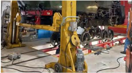
Nr. 6 werden für die Kesselinspektion im Stillstand durch den SVTI vorbereitet. Die HG 4/4 704 wurde nach der dritten Saison auf der Furka-Bergtrecke zur Kontrolle ausgeacht. Eine Durchführung von einer Revision R1 ist diesen Winter an keiner Lok notwendig.
