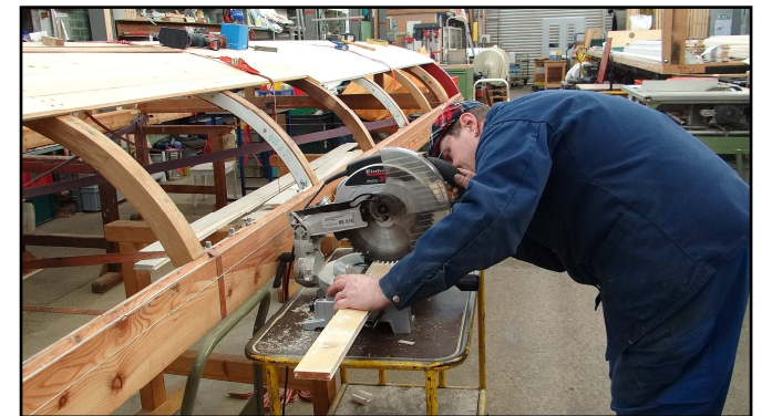
Aufbau des Wagendaches in bequemer Arbeitshöhe
