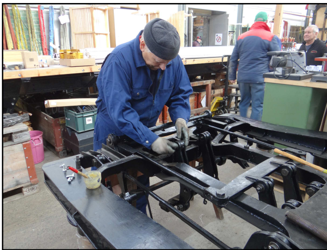
Montage des Bremsgestänges der Drehgestelle.
