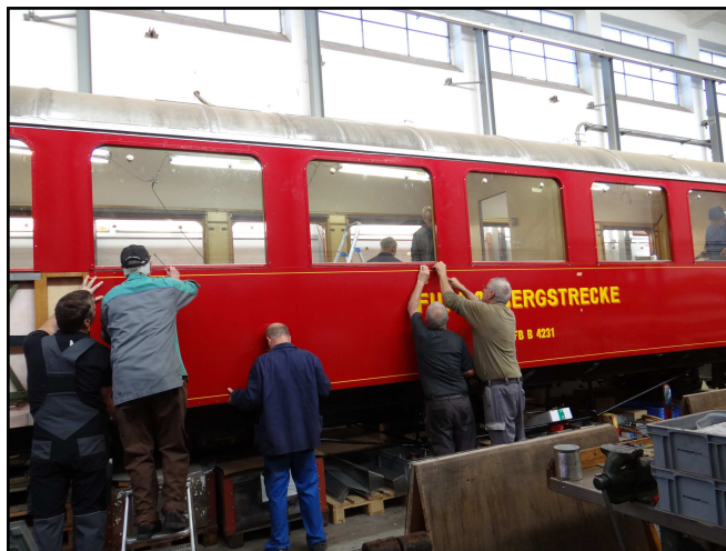
Die Bleche der Wagenverkleidung wurden sorgfältig angeschlagen bevor sie lackiert und beschriftet definitiv montiert wurden.
