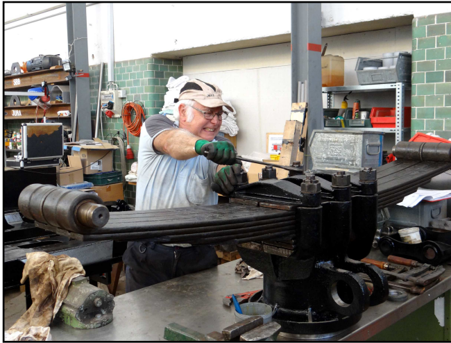
Zusammenbau der Federpakete der Drehgestelle nach kompletter Zerlegung, Kontrolle und Schutzanstrich.
