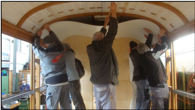
Montage der Platten des Dachhimmels mit vereinten Kräften
