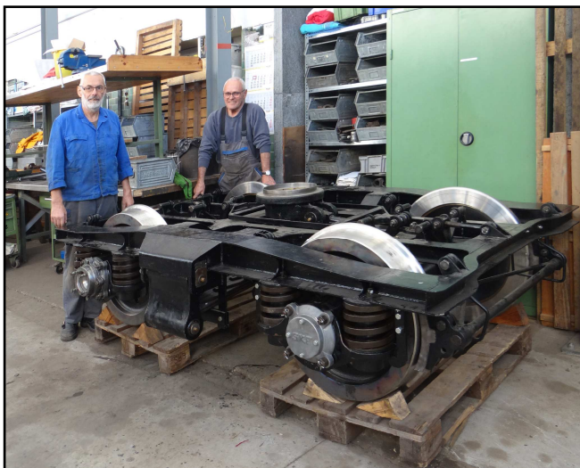
Das fertig montierte Drehgestell geht auf Lager.
