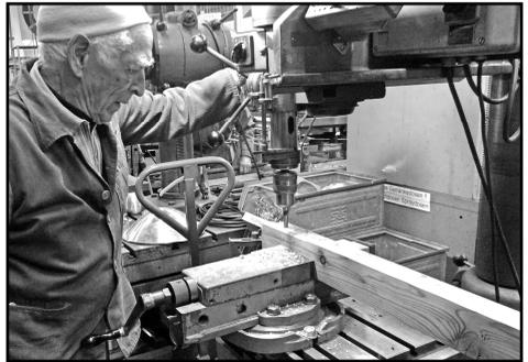
*Alle erforderlichen Bohrungen an den Bodenbalken werden präzise erstellt.*
