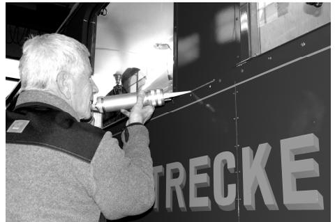
*Die Stösse zwischen den Aussenblechen werden mit Leisten abgedeckt und mit Silicon versiegelt*
