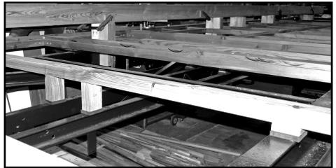
*Distanzstücke stützen über Gummipplatten das Gewicht des Wageninhalts ab.*
