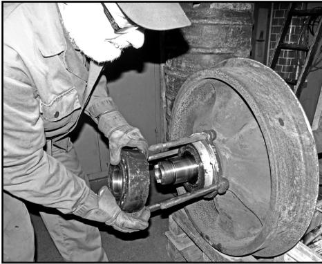
*Abziehen der Radlager zur Reinigung und Kontrolle*
