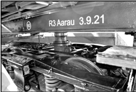
*Präzises Einfädeln der Drehzapfen in die Drehgestelle*
