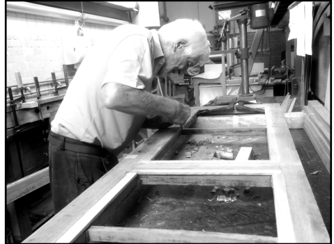
Aufwendige Aufarbeitung der Abteil- und Aussentüren
