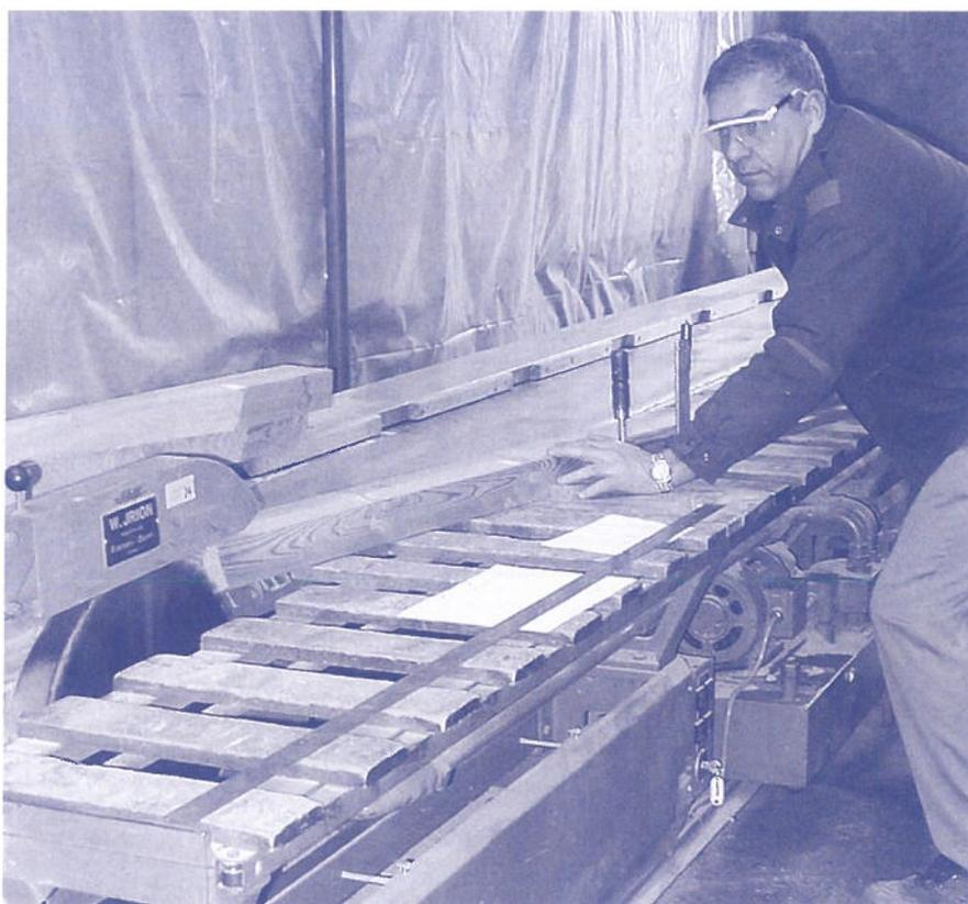
Die neue Schlittensäge ist unersetzlich für die Herstellung der Träger
