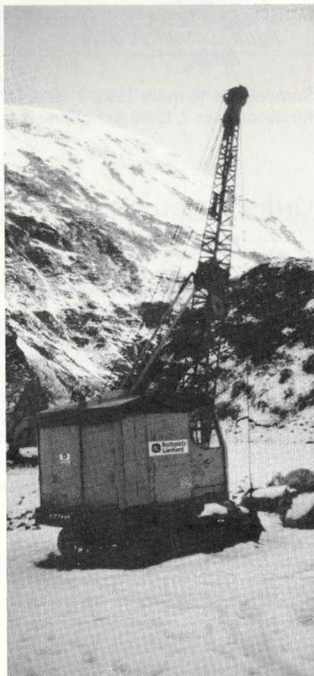
Ein neues «Gerät», ein Seilbagger, ergänzt den Maschinenpark der DFB.
