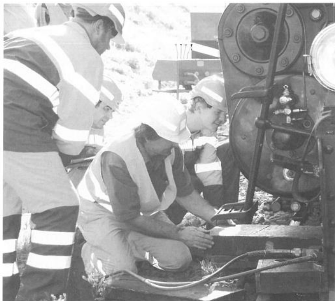
Das Team des RhB-Hilfszuges beim Aufgleisen der gestrandeten HG 3/4. L'équipe du train de secours RhB lors du réentrainement de la HG 3/4.
