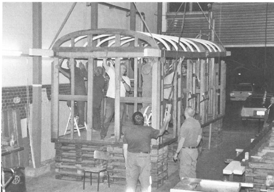
Aufsetzen des Daches auf die Träger des Kastens des B 2206 Pose du toit sur les supports de la caisse du B 2206
