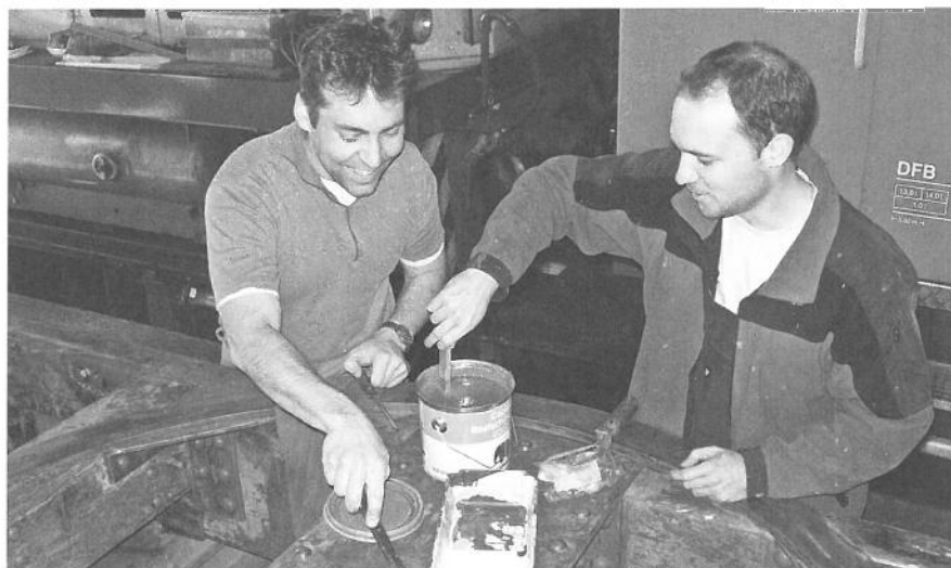
Federico Rossi mit Stefan Gretener am Grundieren des Fahrgestells der ehemaligen FO-Schneefräse Xrote 4931
