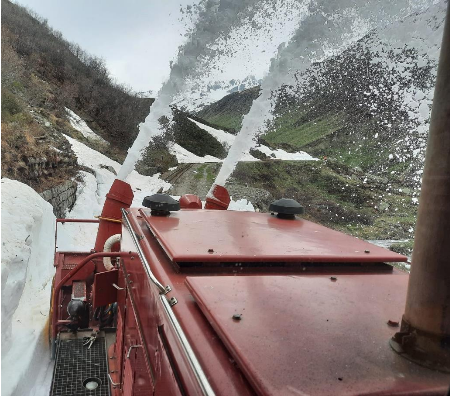
Mit der HGM 51 und Anbaufräse räumen Nicolas Darioli und Ernst Demonti anschliessend den Rest- schnee weg. Bild: Ernst Demonti.
