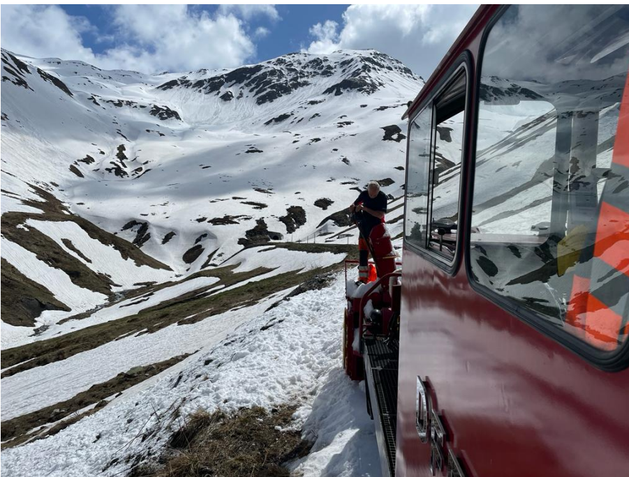
Ernst Demonti entfernt den schweren Schnee aus dem verstopften Auswurfkamin.
