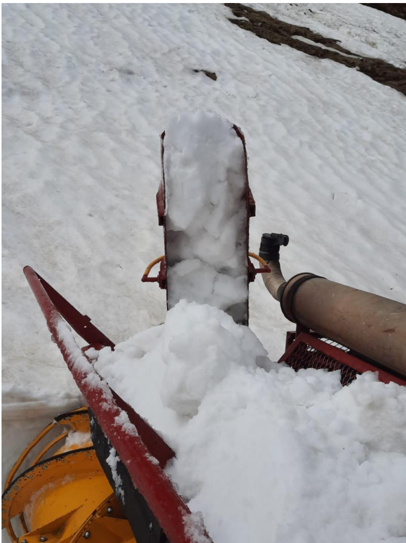
Der schwere Nassschnee verstopft regel- mässig das Auswurfkamin. Bild: Ernst Demonti.
