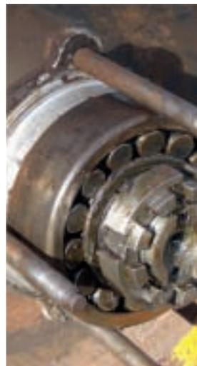
Die neuen Bremszahnäder werden von der RhB auf die Achsen aufgebracht
