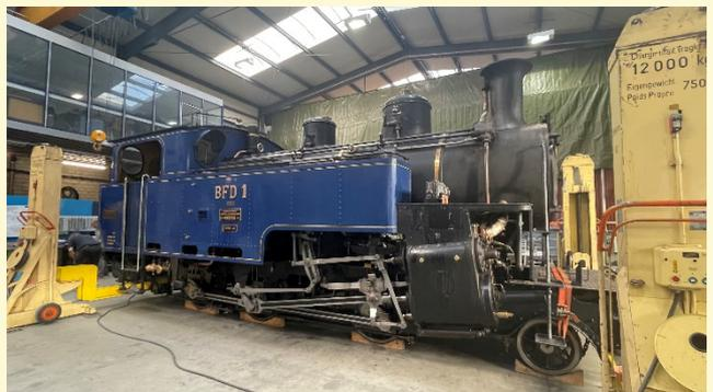
Die Lok HG 3/4 Nr. 1 ist vom Tieflieger abgehoben und wird, nach der Demontage der ersten Teile, um 08:30 Uhr wieder auf sicherem Boden platziert. Bald beginnen an dieser Lokomotive die Demontearbeiten.
