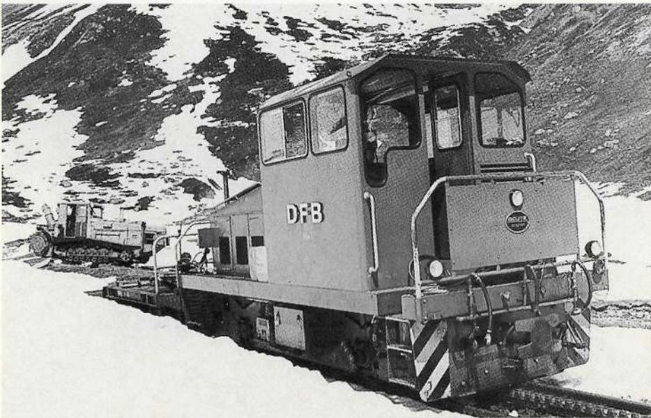
Die HGm 2/2 mit Tiefgänger wartet bei der Station Tiefenbach ungeduldig darauf, die Schneefräse an die Schneefront zu verschieben.
