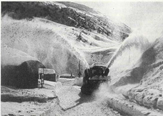
Schneefräse Peter Baujahr 1966 Eigengewicht 12,5 To PS 240 Antrieb Diesel-hydraulisch
