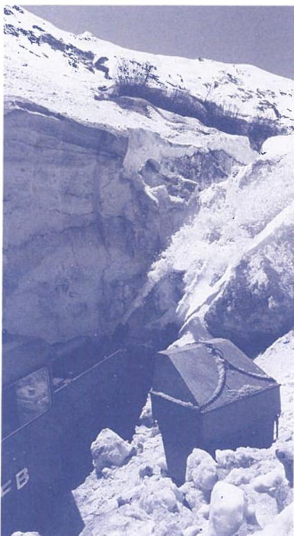
Schneeschleuder an der Diesel-Lokomotive
