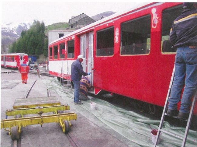
Umlackierung und Beschriftung der Mitteleinstiegswagen Vernissage et marquage des voitures à accès médian (Foto A. Zulauf)
