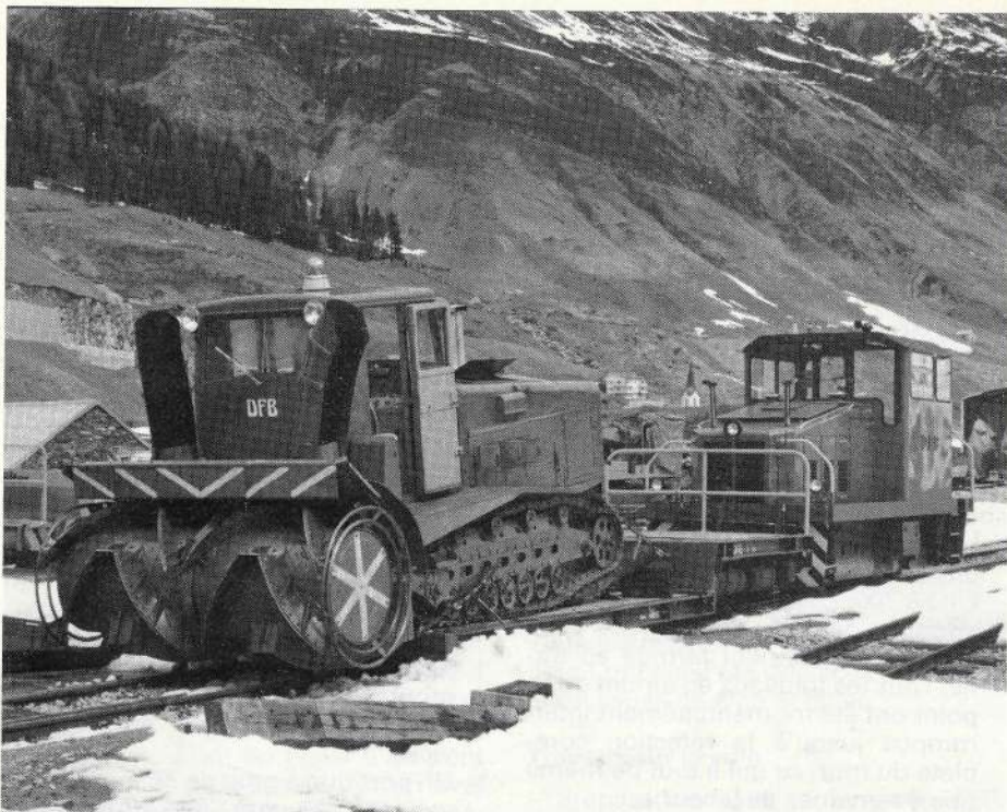
Ein neues Gespann der auf dem Tiefgangwagen X 64 fest montierten «Peter»-Schneefräse vor der Lok HGm 2/2. Diese Räumart hat sich bei den ersten Versuchen gut bewährt, und die Strecke Realp-Wilerbrücke konnte bereits am Montag, 9. April 1990, geräumt werden.
