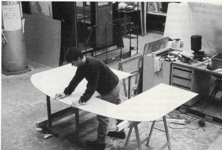
Konstruktion Abteilwand Gepäck 2. Kl. Construction de la cloison du compartiment 2cl. Anschleifen der Innenwandplatte 1. Klasse La plaque de la cloison intérieure préparée.
