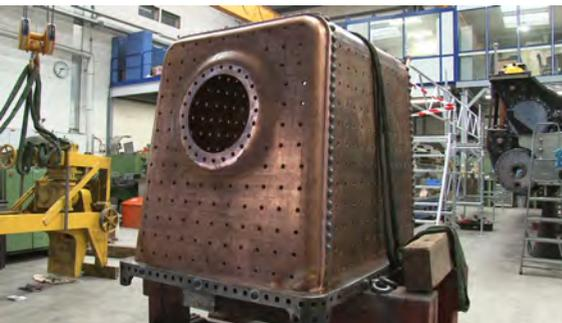
Auf Grund der guten Betriebs-Erfahrungen mit den alten genieteten Kesseln mit Kupferfeuerbüchse legen wir grossen Wert auf den Erhalt dieser Bauart.
