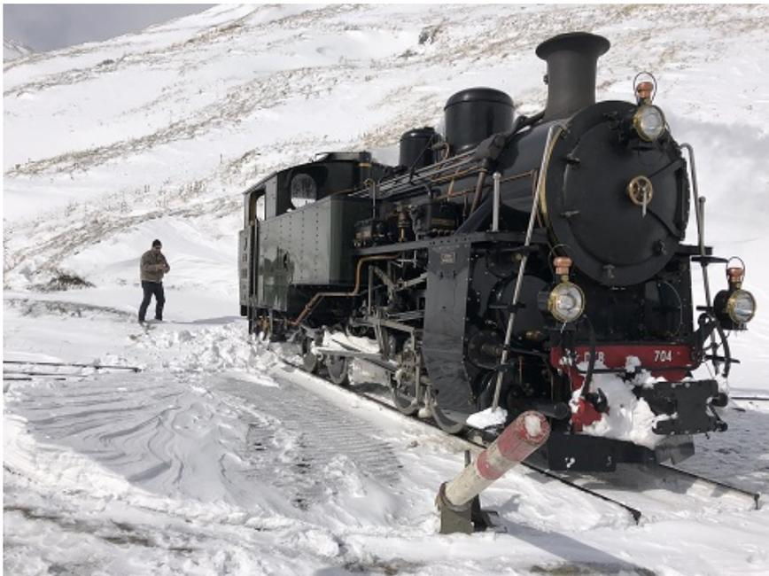
Die Hg 4/4 704 wird auf der Drehscheibe der Station Furka abgedreht.
