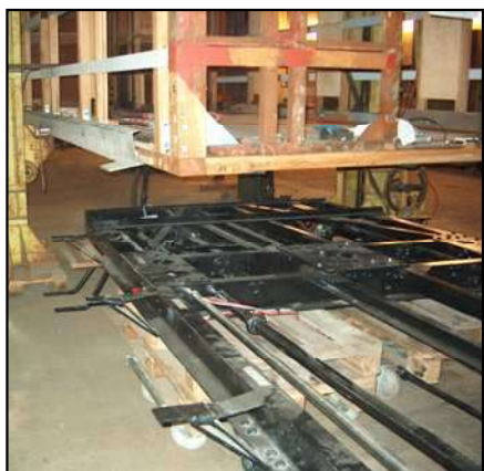
Aufsetzen des LSE-Kastens auf das revidierte Chassis des BVZ J 2407
