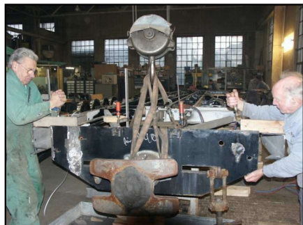
Montage der Puffer
