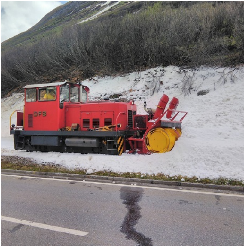
Die HGM 51 mit Anbaufräse erreicht von der Station Muttbach-Belvédère kommend den Bahnübergang Furkastrasse. Damit ist die eigentliche Schneerräumung beendet.
