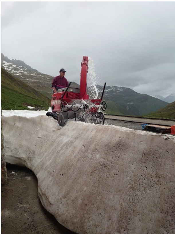
Marcel Schild und Ruedi Schwarz räumen den Schnee vom Vorplatz des Stationsgebäudes. Weil der Schnee schwer ist, ist die Fräs- und Auswurfleistung der YANMAR Fräse sehr schlecht. Bei diesen Schneeverhältnissen bewährt sich diese Fräse überhaupt nicht.
