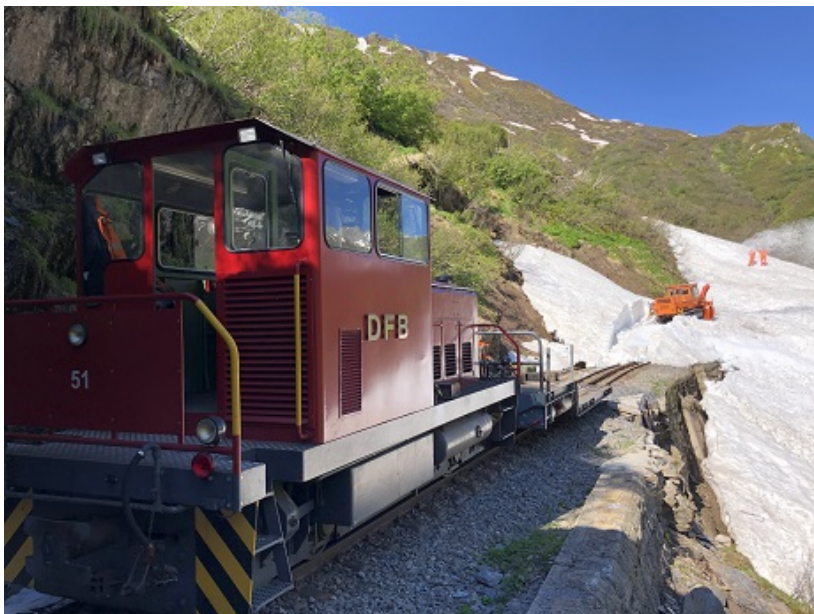
Nachdem die INTRAC Fräse mit dem Tiefgänger vom Lawinenkegel zwischen Tunnel 3 und Tunnel 2 zum Lawinenkegel oberhalb des Tunnels 2 geführt wurde, fährt die HGM 51 zum Stützpunkt Realp zurück. Dort wird die Anbaufräse wieder montiert.
