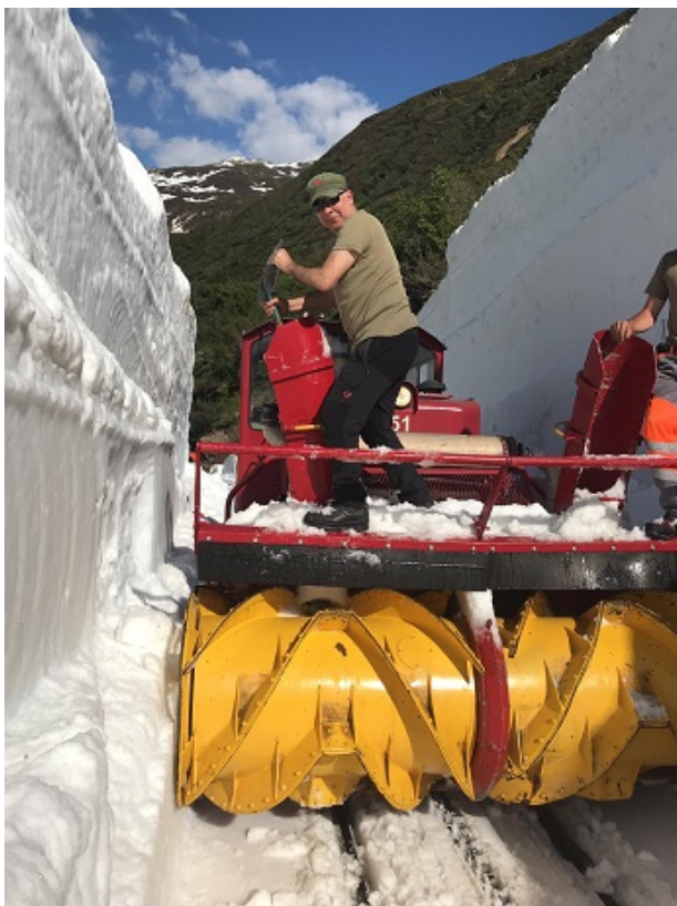
Der schwere Schnee verstopft regelmässig die Kamine der Anbaufräse der HGM 51. Patrick Smit drückt den festgepressten Schnee im Kamin nach unten in die Frästrommeln.
