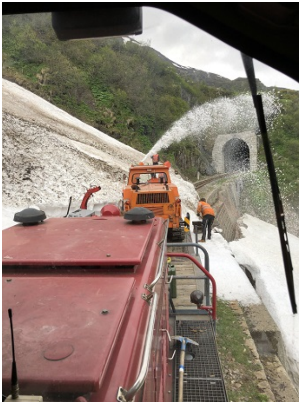
Langsam bewegt sich die INTRAG Fräse vom Tiefgänger auf das Schneebett, das Stephan Stauber auf den schneefreien Bahnkörper geschaufelt hat.
