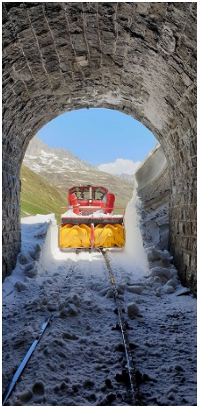
Die HGM 51 mit Anbaufräse beim östlichen Portal des Scheiteltunnels.
