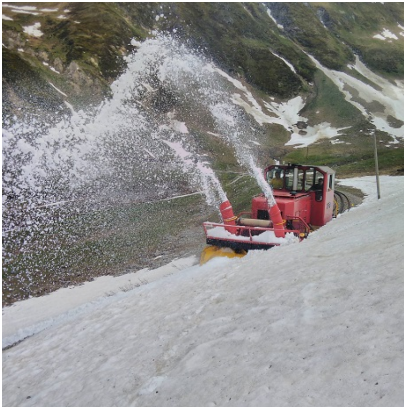
Die HGM 51 mit Anbaufräse kurz nach der Zahnstangeneinfahrt der Station Muttbach-Belvédère.
