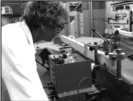
*Präzises Bohren aller Ausnehmungen ist Voraussetzung, dass beim Zusammenbau alles passt*
