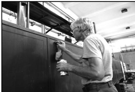
*Vorbereitung der Wagenwände für die Neulackierung.*
