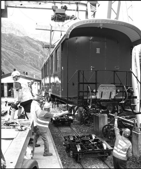
*Absetzen des Wagenkastens auf die Drehgestelle in Realp*
