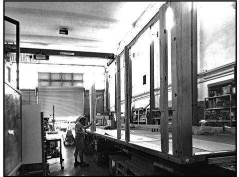
*Probeaufbau einiger Kastenpfosten*
