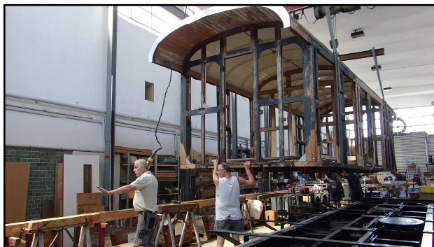
Rücktransport des Wagenkastens auf das revidierte Chassis
