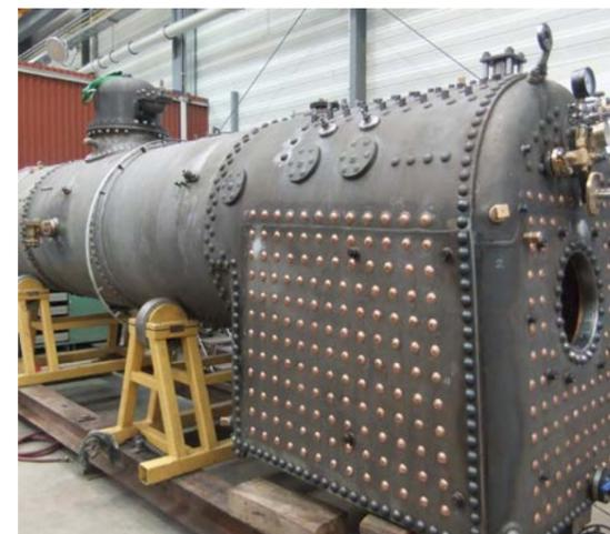
Fertiger Kessel zu Lok 704 (noch ohne Isolation und Kesselverschalung)
