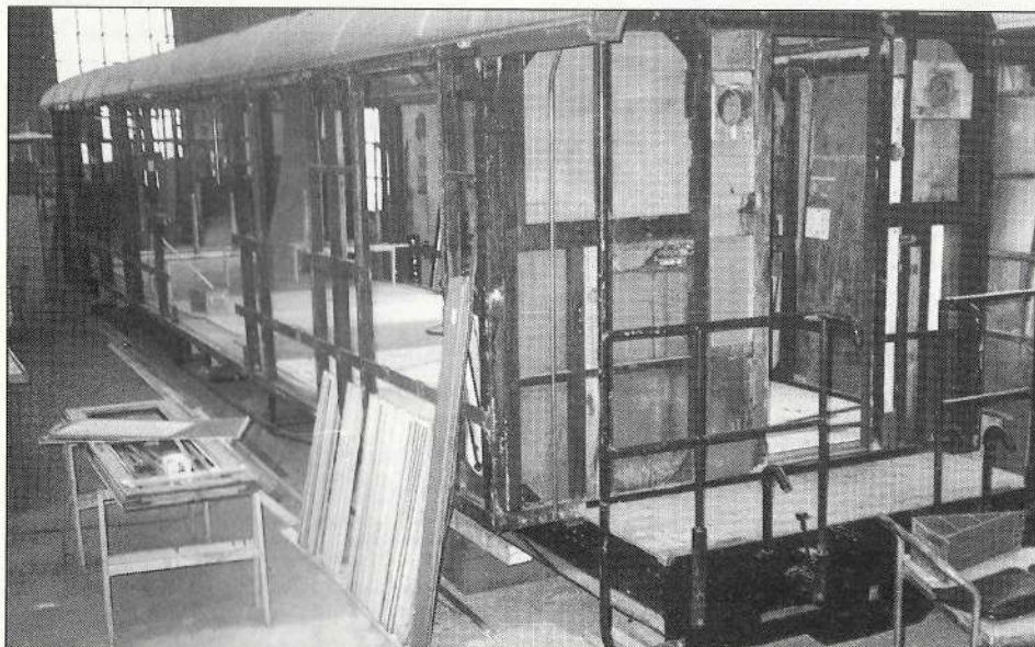
Der zerlegte Holzkasten ex Brünig SBB BC 454 in Werkstatt Aarau Foto: W. Beer
