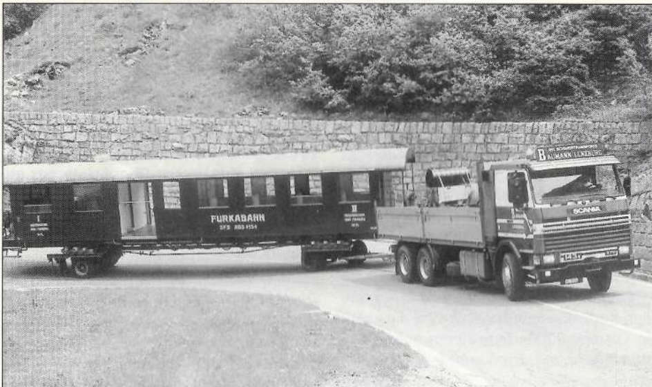
... dass wir alle die Kurve kriegen. Der Transport des ABD 4554 von Aarau nach Realp erfordert vom Fahrer einiges an Fahrkünsten und Aufmerksamkeit. Der Wagenkasten wurde nachträglich auf die Drehgestelle abgesetzt. So konnte möglichen Problemen bei Brücken und Galerien (Durchfahrhöhe) begegnet werden. Foto W. Beer
